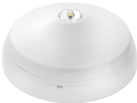
La famiglia CBE comprende lampeggianti a soffitto di colore rosso e bianco che assicurano una larga copertura di volume ottico e basso consumo di corrente. L'utilizzo di una particolare lente sferica consente di essere conforme allo standard EN54 part 23 Classe C con copertura C3-7,5 utilizzando un unico LED riducendo il consumo totale di corrente. Il design dal basso profilo che si protrae di soli 45mm dal soffitto rende il prodotto discreto e non invasivo.
